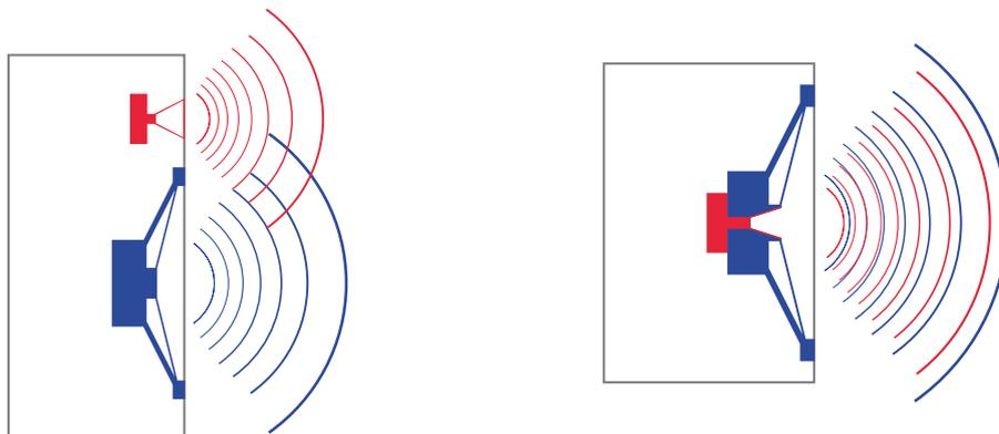
В большинстве наших акустических систем мы применяем динамики с коаксиальной конструкцией. Особенностью данной конструкции является то, что среднечастотный и высокочастотный излучатели находятся на одной оси (СО совместно-AXIAL ось).
