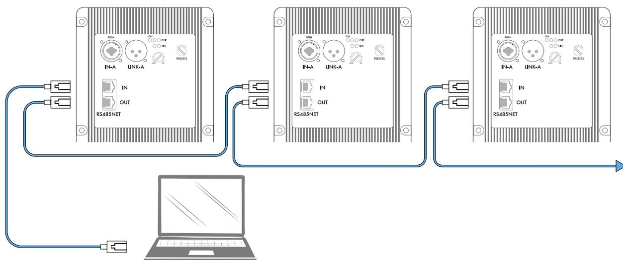
**Работа DSP-процессора происходит полностью в автономном режиме. Подключение к компьютеру требуется только для внесения изменений в настройки.**
