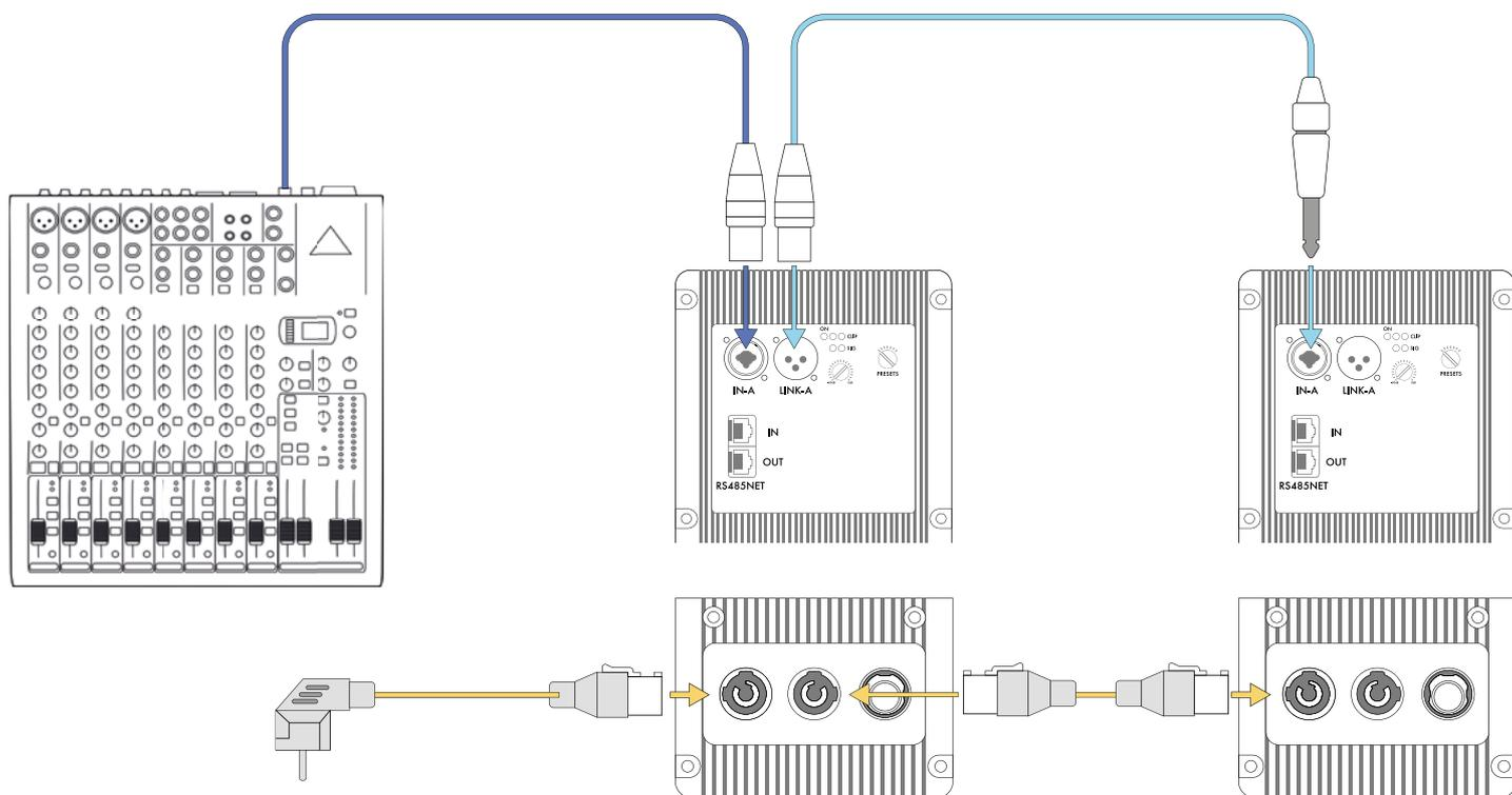
Подключение акустических систем также можно производить с помощью комбинированного кабеля сигнал + питание DS Proaudio Combo-Cable 2.5m.
