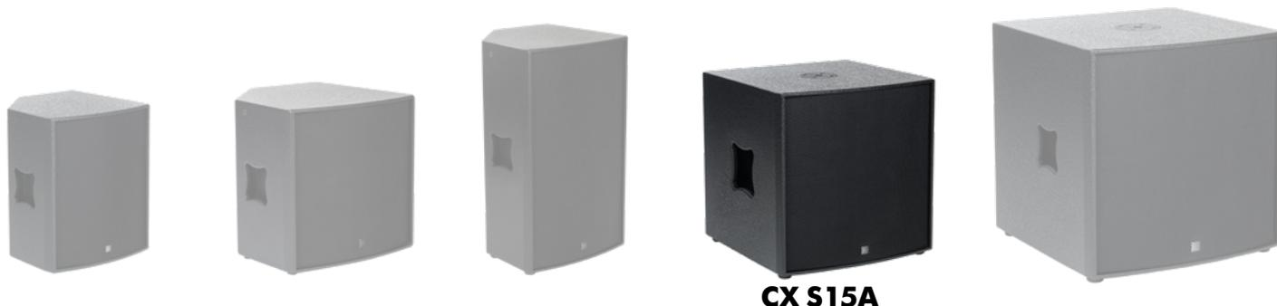
Активный сабвуфер, 15", мощность 1200 Вт, звуковое давление продолжительное/пиковое 127/133 дБ, частотный диапазон 45-300 Гц (+/-3 дБ), DSP (x-over, delay, PEQ x9, limiter), 25 кг.
